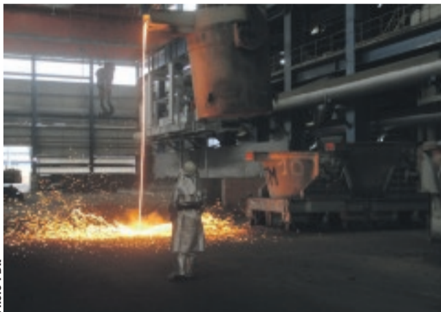
Place à la transformation. ici, une opération de coulée.
