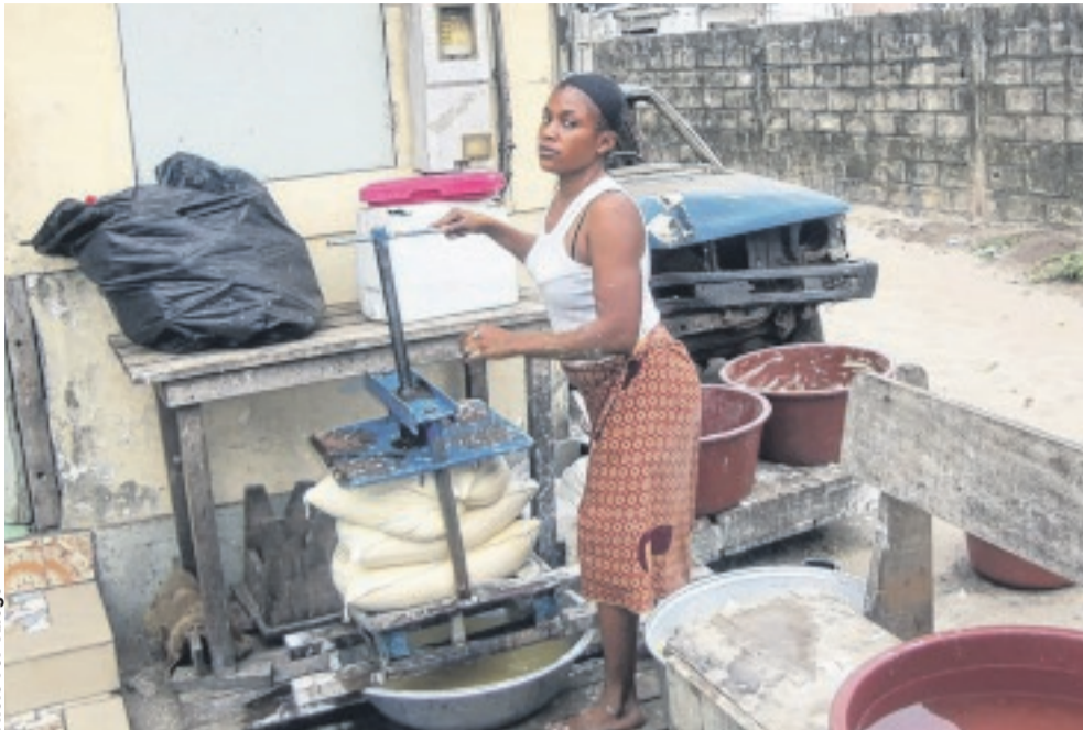
La phase de déshydratation proprement dite.
