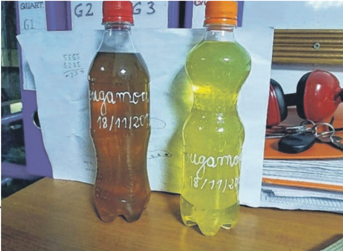
Quelques échantillons du gas-oil prélevés. Celui de gauche serait de mauvaise qualité. Photo de droite : Lui aussi de mauvaise qualité, cet échantillon présente même un dépôt boueux au fond de la bouteille.
