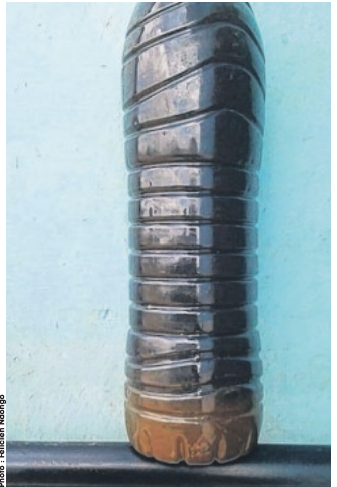
Quelques échantillons du gas-oil prélevés. Celui de gauche serait de mauvaise qualité. Photo de droite : Lui aussi de mauvaise qualité, cet échantillon présente même un dépôt boueux au fond de la bouteille.
