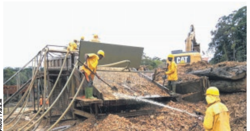
...et une laveuse manuelle, pour extraire le précieux minerai de la terre.
